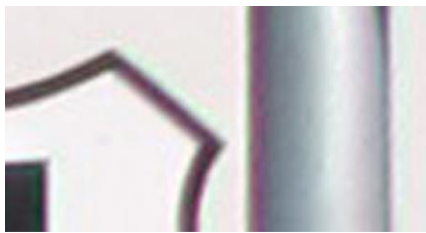
Abbildung 42: Korrigierter chromatischer Querfehler
